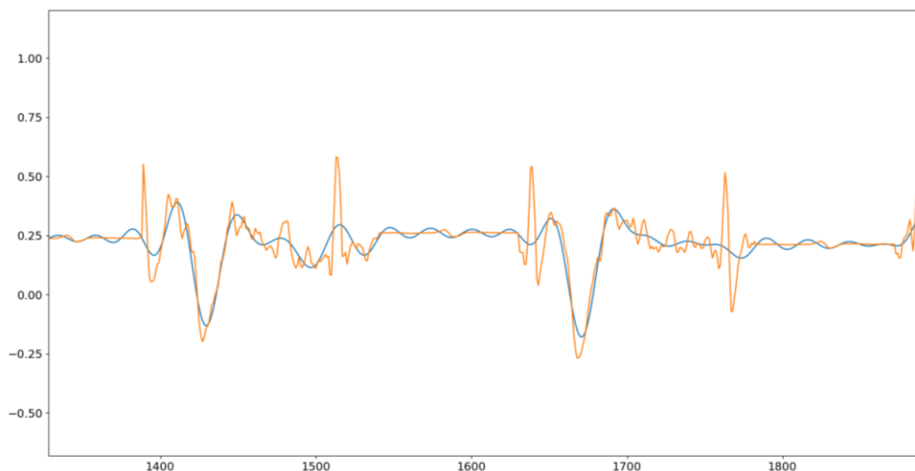
Рис. 2 Отображение данных ЭКГ плода до и после применения фильтра Фурье.
