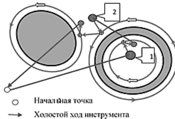
Рис. 3 Пример схемы резки деталей с применением разных техник резки.
