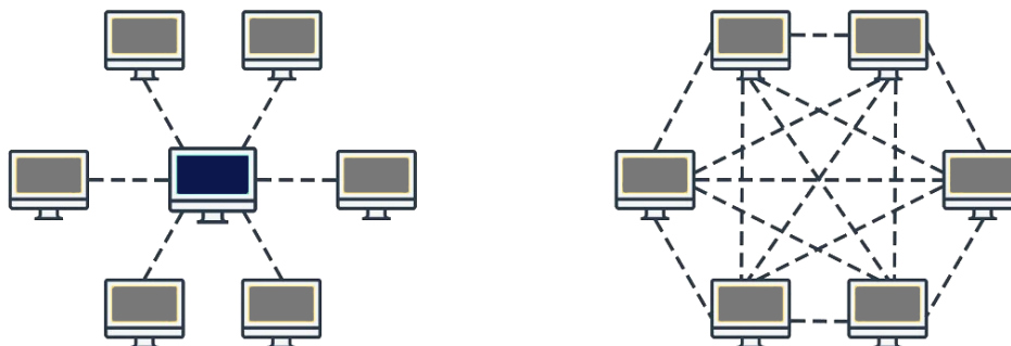
Рис. 3 Схема архитектуры на основе центрального сервера и пиринговой сети
