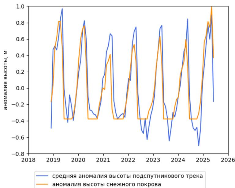
**Рис. 2** Сравнение вариаций средней аномалии высоты подспутникового трека с аномалиями высоты снежного покрова на метеостанции Новый Уренгой
