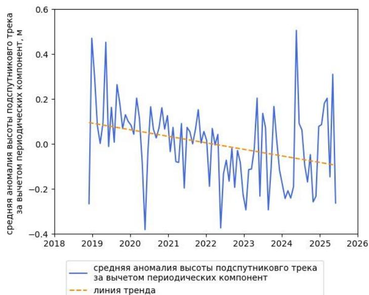
**Рис. 4** Вариации средней аномалии высоты подспутникового трека за вычетом периодических компонент с частотами 1, 2 и 3.1 год<sup>-1</sup>
