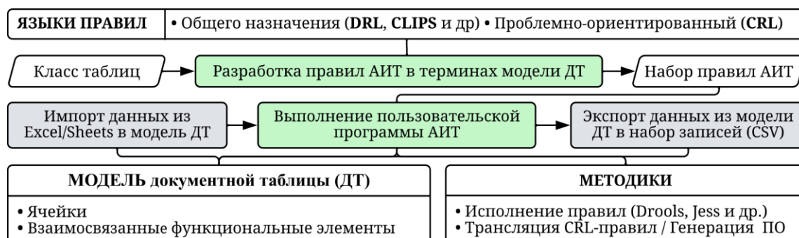
Рис. 13 Метод автоматизации АИТ: основные шаги и компоненты
