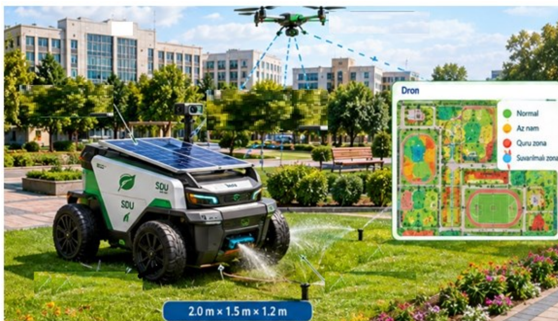
Рис. 2. Мобильный робот для дополнительного полива, очистки и стрижки газона
